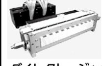
現在も佐和式ダイレクトジャカードを製造する国内唯一のメーカーです。西陣ピッチ・桐生ピッチ・エンドレスピッチの各社メカジャカードに対応します。CGS2フォーマットMiniコントローラを標準搭載
